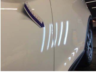
Kapı, sol ön, Kapı, sol ön > Ezik
