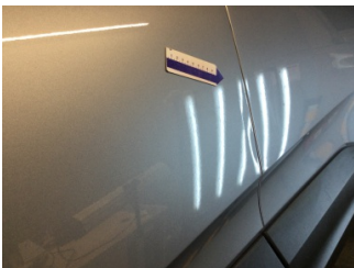
Kapı, sol ön, Kapı, sol ön > Ezık
