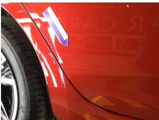
Kapı, saė arka, Kapı, saė arka > Ezik
