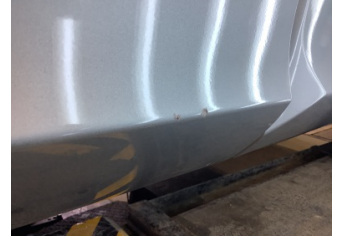
Kapı, sol ön, Nikelaj, alt > Deforme Olmuş
